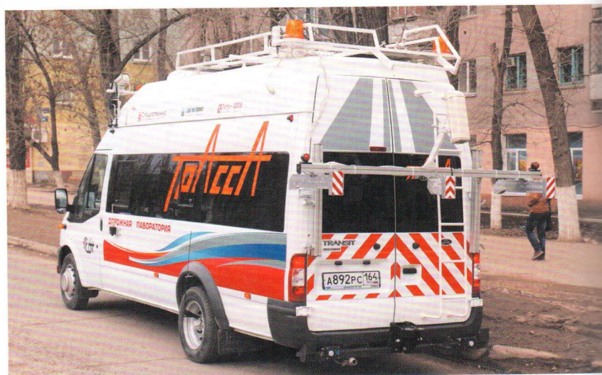
Комплексная передвижная дорожная лаборатория «Трасса»
